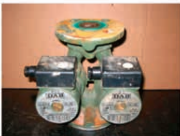
Состояние двойного насоса
